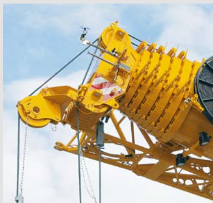
Дополнительная блочная головка, откидываемая в сторону
