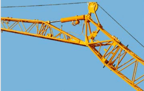
Гидравлически выставляемый откидной удлинитель (0° - 40°)
