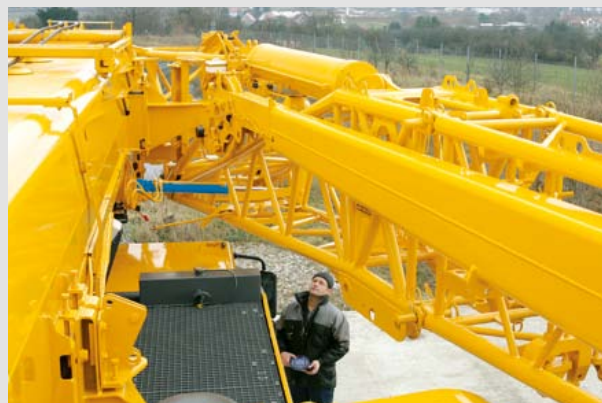
Дополнительная блочная головка, откидываемая в сторону
